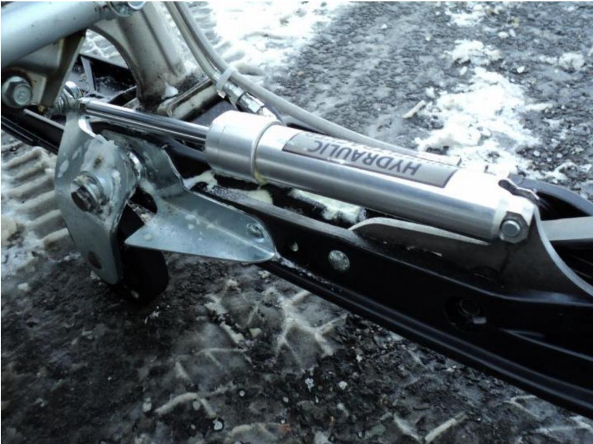
Les pièces sont fabriquées au Québec et assemblées chez le fabricant des Wheeltracker. Leur qualité de fabrication irréprochable en fait un produit haut de gamme qui peut être installé sur une motoneige puis déplacé sur une autre motoneige d'une autre marque, en changeant simplement les supports de la pompe et des roues.
